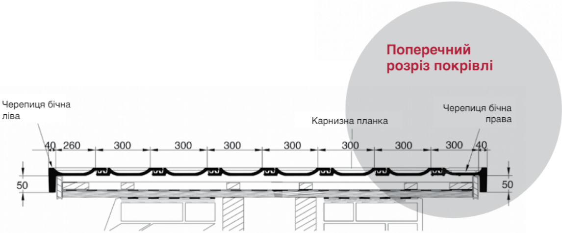
Поперечний розріз покрівлі
